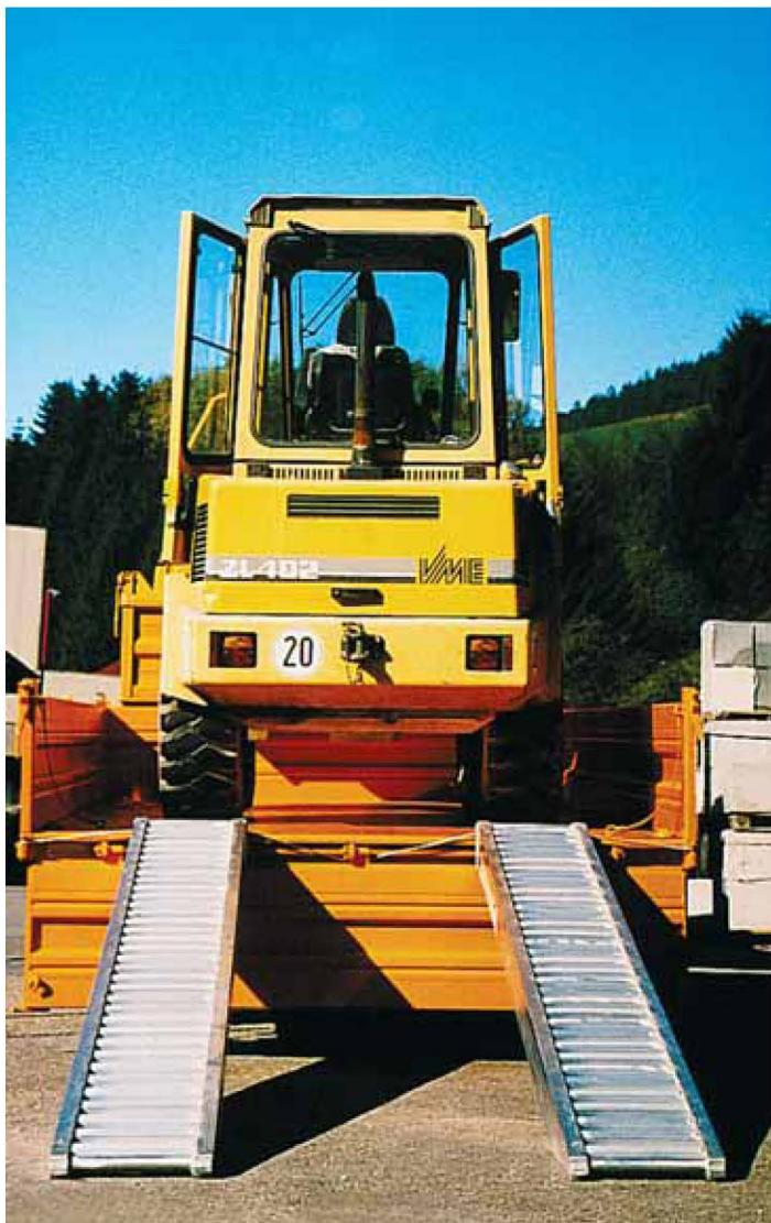
Κατασκευασμένες για τη φόρτωση μεσαίου έως βαρύ εργοταξιακού εξοπλισμού, η AVS 150 έχει ένα μεγαλύτερο και πλατύτερο πέλμα πό τους μικρότερους τύπους. Αναδιπλούμενες ράμπες και με κούρμπες είναι διαθέσιμες.
