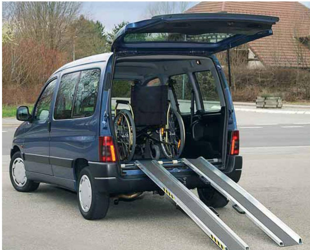
Αυτές οι ράμπες μπορούν να εγκατασταθούν μόνιμα στο εσωτερικό του οχήματος. Ο περιστρεφόμενος και συρόμενος μηχανισμός της ράμπας χρησιμοποιεί ρουλεμάν για ευκολία στη χρήση. Κατά τη μεταφορά, οι ράμπες διατηρούνται κατακόρυφα μέσα στο όχημα με τους ιμάντες ασφαλείας που παρέχονται. Εάν χρειαστεί, η επιφάνεια της ράμπας μπορεί εύκολα να ανανεωθεί.
